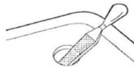
Limar los bordes del orificio
